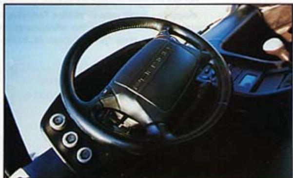
La planche de bord reçoit des éléments en aluminium taillés dans la masse.
